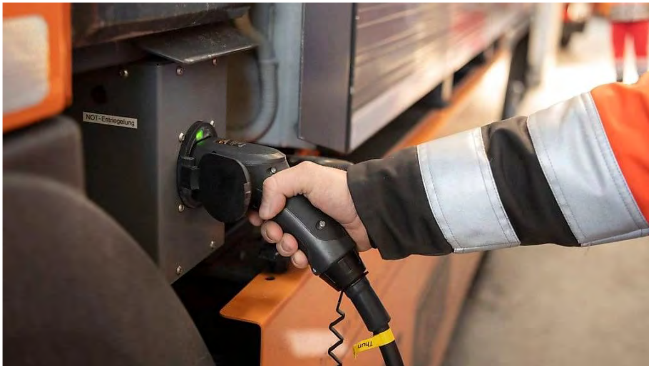
Ein Angestellter der Stadt Thun lädt einen elektrisch betriebenen Kehrichtlastwagen auf. (Archivbild) © KEYSTONE/CHRISTIAN BEUTLER
