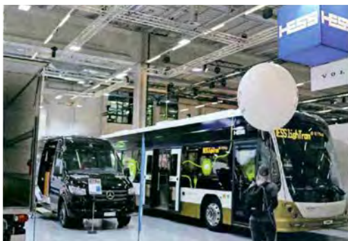
Die Carrosserie Hess AG ist der letzte echte Fahrzeughersteller der Schweiz. Er brachte seinen internationalen Bestseller LightTram in der elektrischen 12-m-Solovariante mit Depottladung mit. La Carrosserie Hess AG est le dernier véritable constructeur automobile en Suisse. Il a emmené avec lui son best-seller international LightTram dans la version électrique solo de 12 m avec chargement en dépôt.
